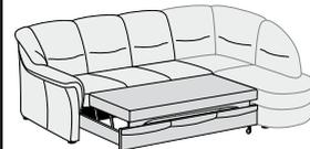
Die **Rückverwandlung** erfolgt, indem man den Schwenkrahmen nach unten führt und zur Sitzposition hineinschiebt.
