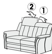
Die Rückenlehnen besitzen eine integrierte Kopfeilverstellung. Dadurch lässt sich die Lehne stufenlos in die gewünschte Position bringen.
